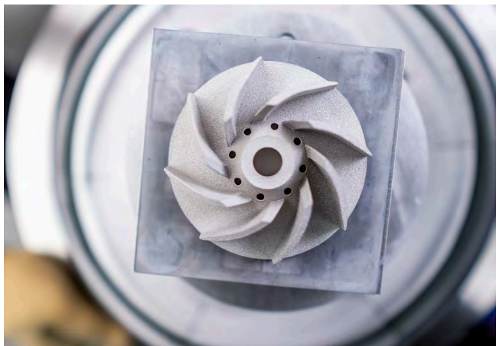
Bauteile werden auf Keramikunterlagen zu Metallbauteilen versintert.
