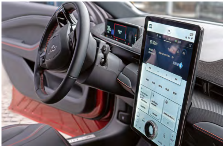
Touchscreen mit einem haptischen Drehsteller, der durchbruchsfrei auf der Oberfläche befestigt ist, im Ford Mustang Mach-E.
