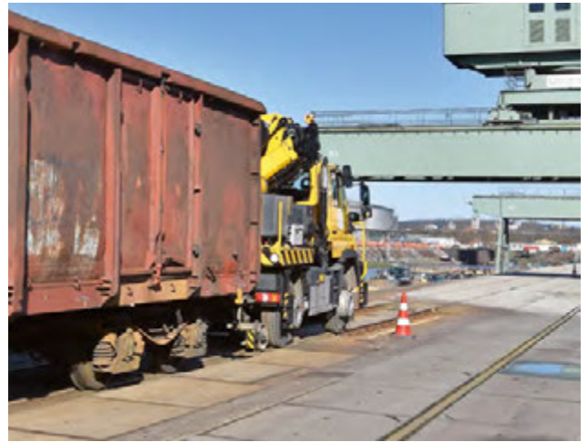
Ein Unimog zieht Eisenbahnwaggons auf die Gleiswaage.
