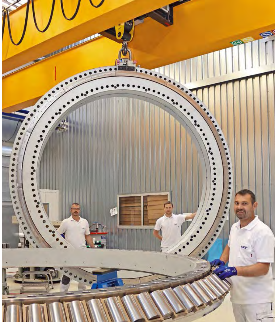
Härter als die Realität: Ein solches Nautilus-Lager hat der 1.200-PS-Prüfstand jüngst auf ein Vielfaches über Normal beschleunigt. Foto: SKF
