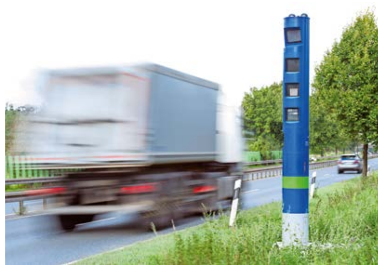
Kontrollsäulen überprüfen zukünftig die Einhaltung der Mautpflicht auf Bundesstraßen.
