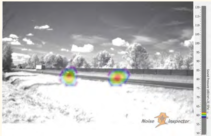
Autovorbeifahrt – Ortung der Rollgeräusche (Direktschall) und Reflektion am Fahrbahnteiler.
