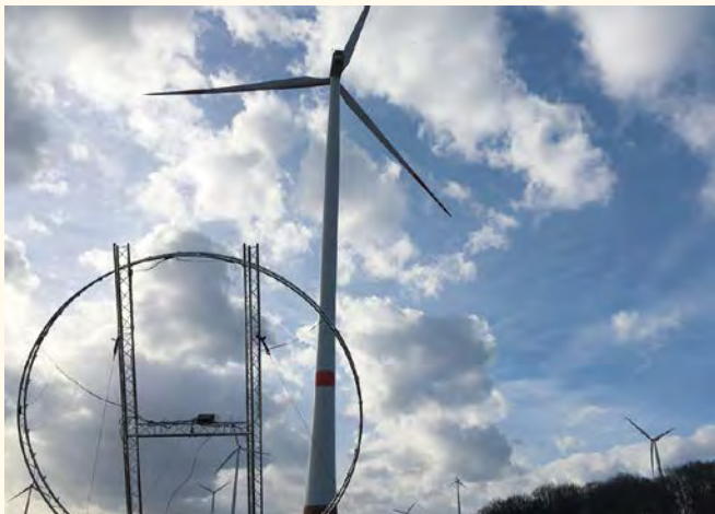
Windarray im Einsatz an einer Windenergieanlage.
