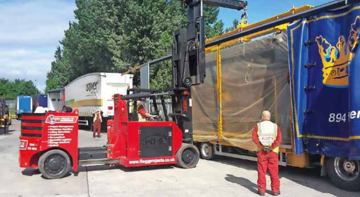
Entladung einer Digitaldruckanlage vom Schwerlasttransporter.
