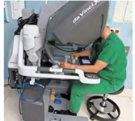
Der Operateur steuert die Roboterarme von einer Konsole aus. Seine Bewegungen werden dabei stark verfeinert und vollkommen zitterfrei.
