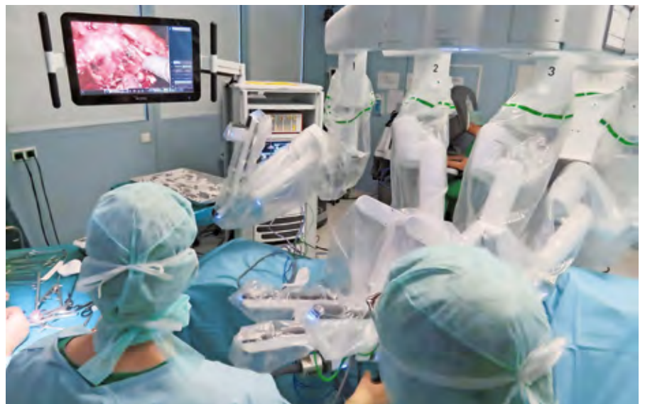
Der Operationsroboter „da Vinci Xi“ ist mit vier Armen an einer horizontalen Aufhängung ausgestattet.
