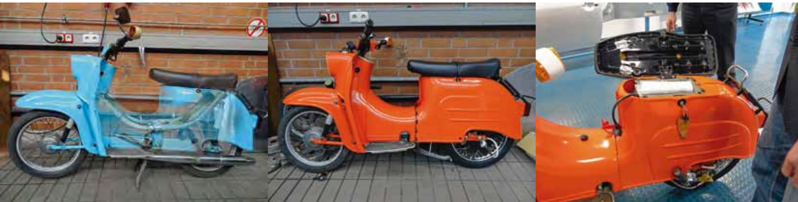
Die Schwalbe vor und nach dem Umbau. Links im Bild die „Bauräume“ für das Innenleben der „Schwalbe“ als Fotomontage.
